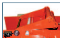
Schlaffseilschalter Slack-rope switch Détection de brin mou
