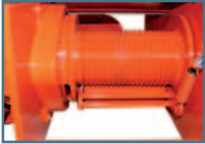
Seilandruckrolle Pressure roller Rouleau presse cable
