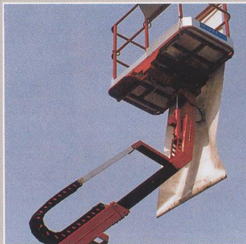
Piattaforma aerea. Installazione di catena portacavi Plataforma aerea. Instalación de cadena portacables Plate-forme aeriene. Installation d'une chaîne porte-câbles
